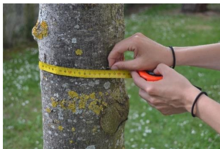
Ilustración 6. Medición de la circunferencia con dendroflexómetro
